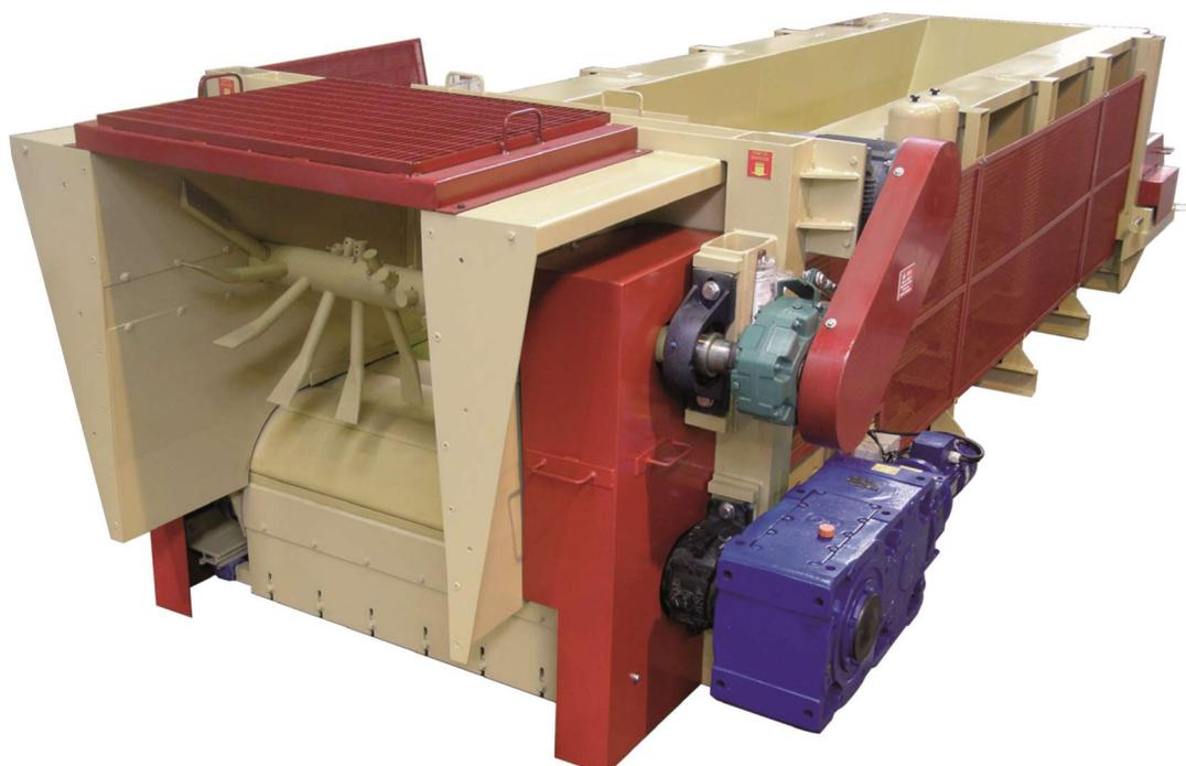
**LE DOSEUR HORIZONTAL À TABLIER MÉTALLIQUE RÉCEPTIONNE ET DOSE LES ARGILES EN PROVENANCE DE LA CARRIÈRE.**
